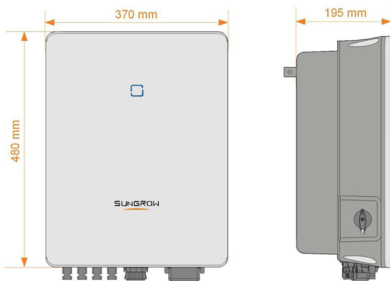
2-3 pav. Keitiklio matmenys (mm)
